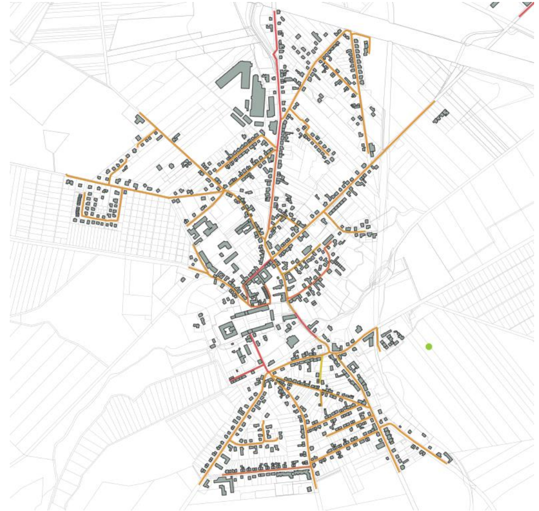
Bildung Wärmestromdichte je Straßenzug
